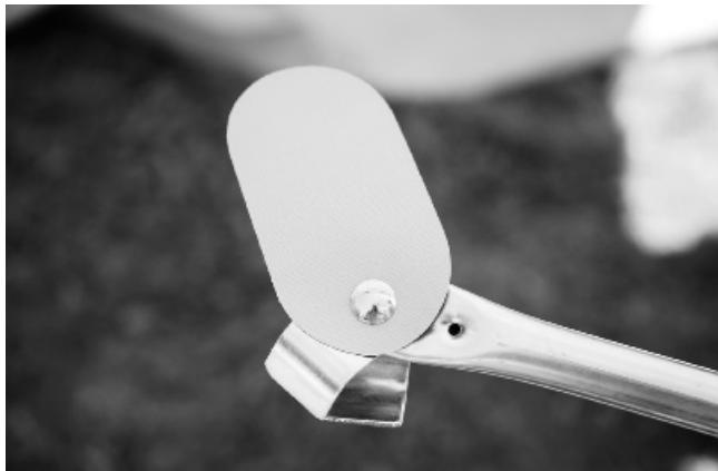
**Correct :** les languettes de protections fournies avec votre auvent DWT se montent sur la pince de fixation. Ceci protègera les toiles d'une usure précoce due au frottement. Contrôler régulièrement le serrage de ces éléments afin de prévenir tout glissement dangereux des barres.
