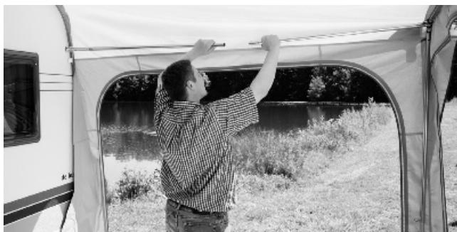
Accrochez la barre de toit dans l'œillet ou dans le vario clip, raccordez cette barre au coin de l'armature, tendez légèrement cette barre et serrez la vis pour toute sécurité.
