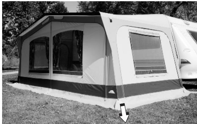
Ziehen Sie die Eckfüße wie der Pfeil es im Bild zeigt. Damit spannen Sie Seitenwand und Vorderwand gleichmäßig. Machen Sie das gleiche mit dem Eckfuß der anderen Seite. Fixieren Sie diese Ecke mit Abspangeleiter und Erdnagel oder Hering.
