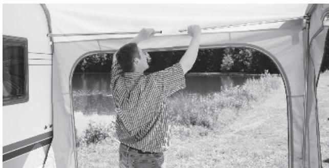
Haak nu een nokstok van een hoek in het oog of in de Vario clip , verbind de stok met de hoek en span deze lichtjes op. Span de schroeven vast.
