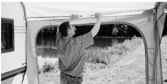
Hängen Sie die seitliche Dachstange in die geschraubten Halteösen oder Vario Clip am Wohnwagen ein, verbinden Sie sie mit dem Seitenwinkel. Spannen Sie die Stange leicht aus, stellen Sie die Schrauben fest.
