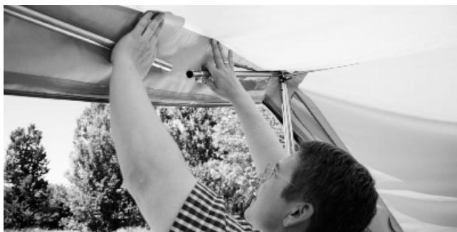
Raccordez alors le coin au milieu de l'armature, réglez l'ouverture télescopique de l'armature en largeur, serrez les vis.
