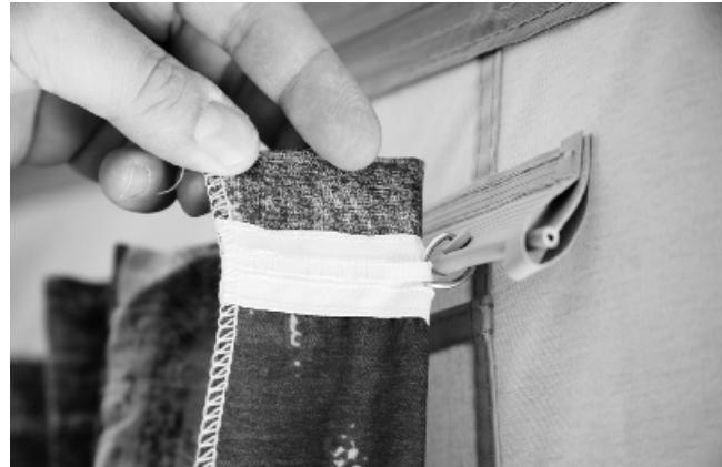
Fixez enfin les protections avant et arrière le long de la caravane afin d'avoir une étanchéité parfaite entre l'auvent et le véhicule.
