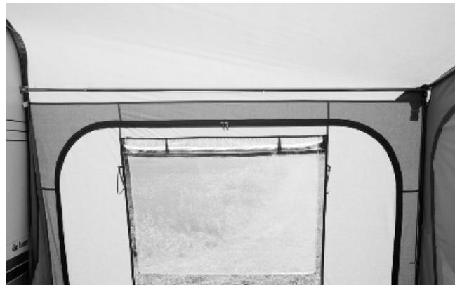
**Mauvais :** la barre de toit n'est pas parallèle et surtout beaucoup trop haute sur la caravane, ceci empêche la tension du toit et du coupe vent de la face avant.
