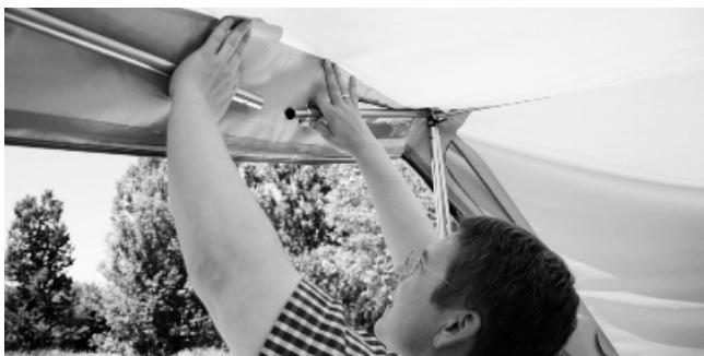
Verbinden Sie diesen Seitenwinkel mit dem Mittelwinkel, teleskopieren Sie die Stäbe leicht aus einander, stellen Sie die Schrauben fest.
